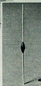
Bild 3. Gleichrichter bis 12,5 kV in Plastikumhüllung (R.T.C.)
